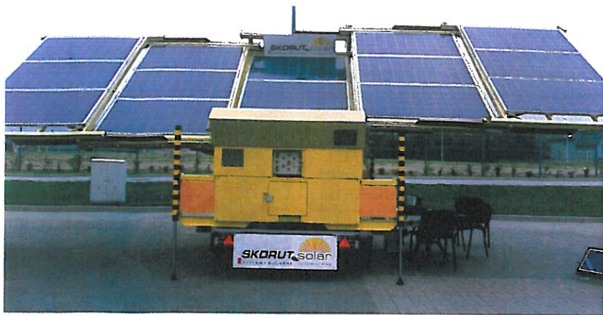
Stacja PV rozłożona do pracy
